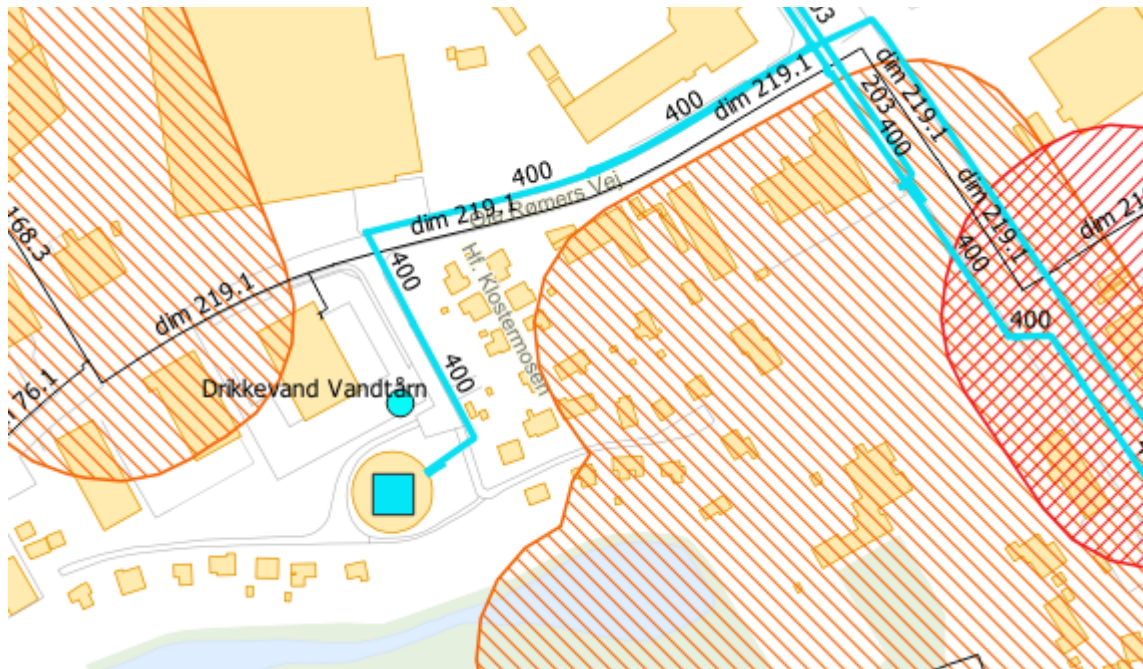
FIGUR 28: VARMEKILDE FOR VARMEPUMPE MED DRIKKEVAND VED VANDTÅRNET HF KLOSTERMOSEN
